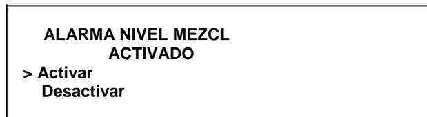
Desactive la función de aviso sonoro oprimiendo el símbolo de flecha descendente para mover la flecha a la opción "Desactivar". Oprima el símbolo SEL para guardar la nueva configuración y regresar al menú. Los iconos de mezcla baja y sin mezcla se iluminarán en el tablero de control cuando baje el nivel de mezcla en la tolva, pero se desactivará la alarma sonora.
